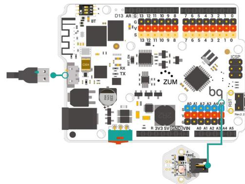
Una vez que has conectados ambos componentes, hay que programarlos. Para ello, utilizaremos el apartado *Bucle principal (loop)* al que añadimos el bloque mostrar por *puerto serie*, al que incluiremos el bloque *Leer sensor de luz* y finalmente una *Espera* de unos pocos segundos:
