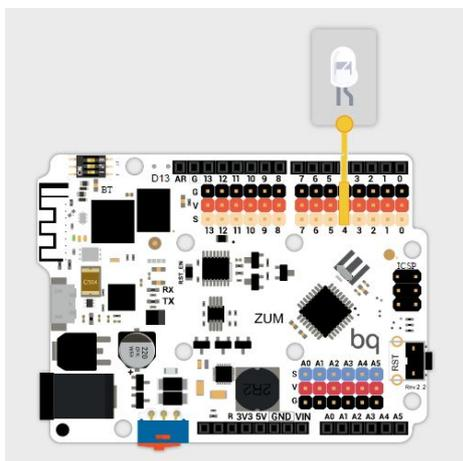
Una vez que tenemos el LED conectado a la placa, deberemos ir a Bitbloq y en la pestaña *Hardware*, arrastrar nuestra placa y el LED, conectándolo al mismo pin que utilizamos en la placa física.
